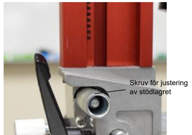
Fig. 50 – Övre styrningar (vy bakifrån)
